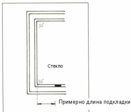
Рис.8 Отступы от внутренних углов фальца остекления изделий при установке подкладок.
